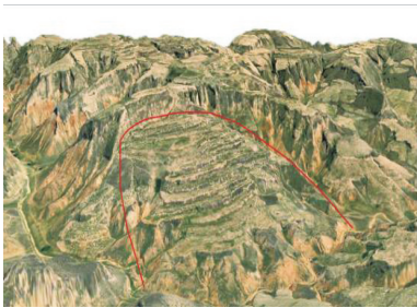
图 8 某滑坡三维遥感判释结果
