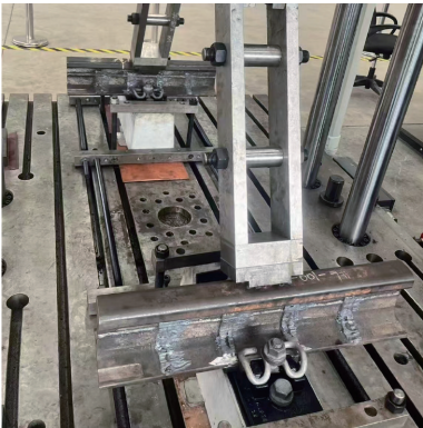
图 17 扣件组装疲劳性能检测
