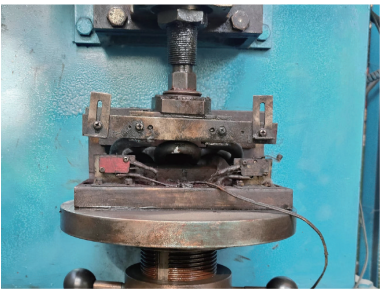
图 16 弹条疲劳性能检测
