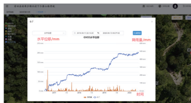
图 15 三维监测数据一体化界面
