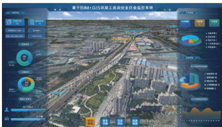
图 11 基于 BIM+GIS 的三维施工场景作业监控
