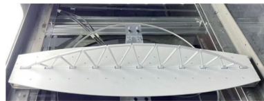
图 13 钢桁架风洞试验模型
